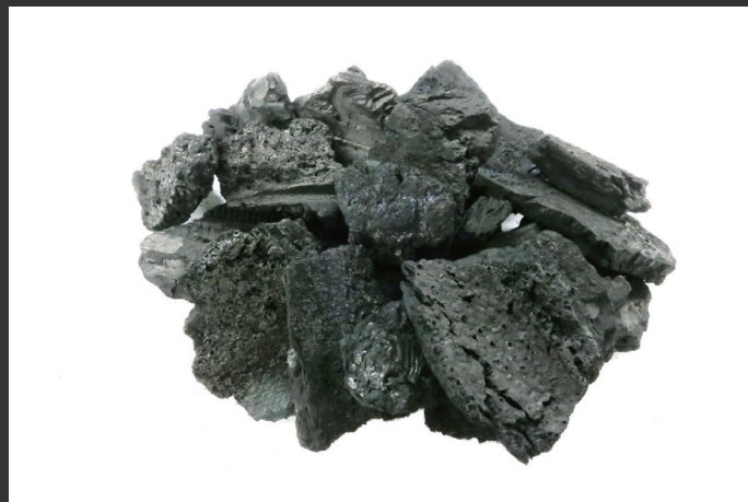
タイヤ電池 ® 電極材の原料 (使用済みタイヤの熱分解残渣物)
